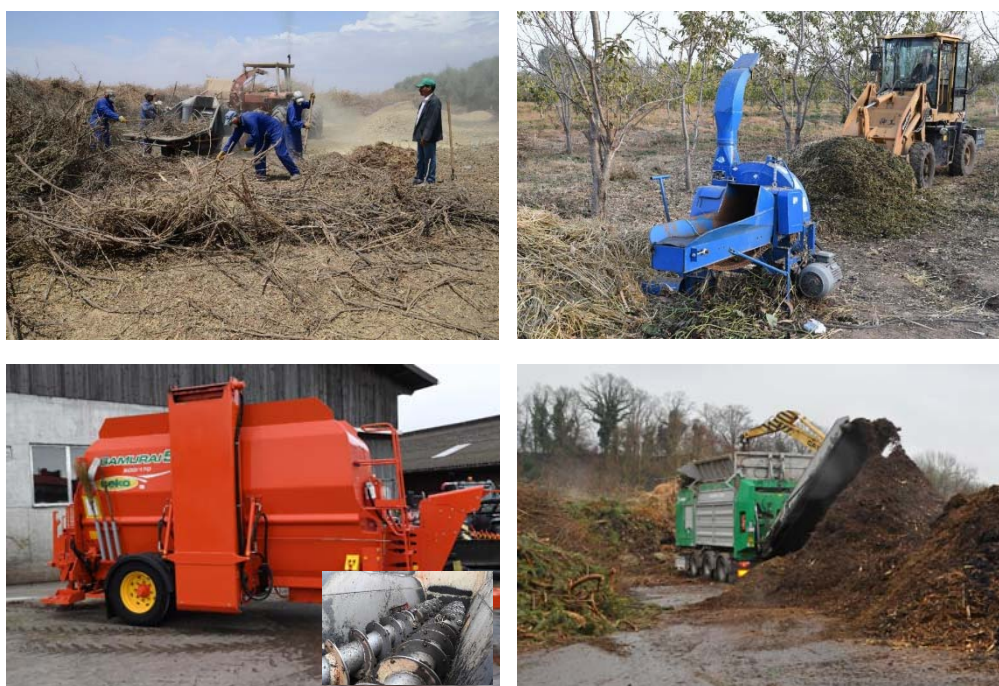
Fig. 9. Exemples de broyeuses pour une installation de compostage.
