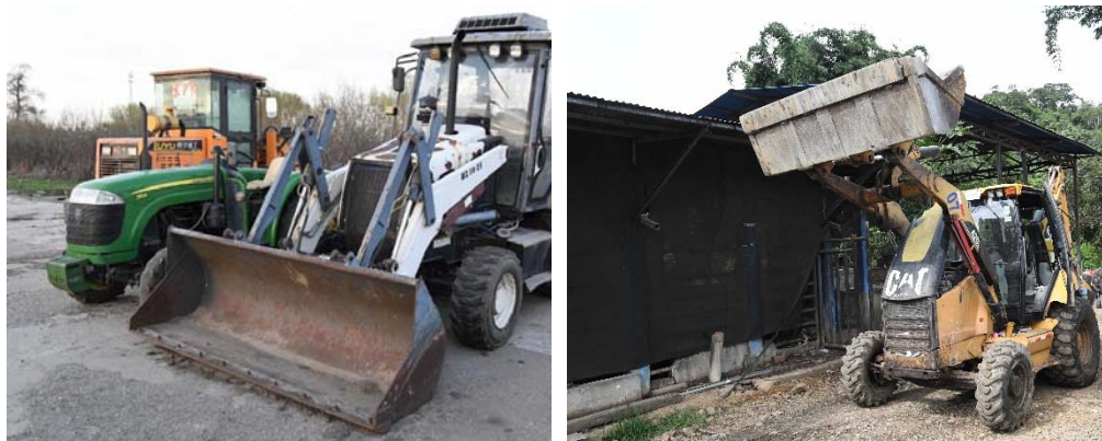
Fig. 8. Exemples de tracteur avec frontal et de chargeuse.
