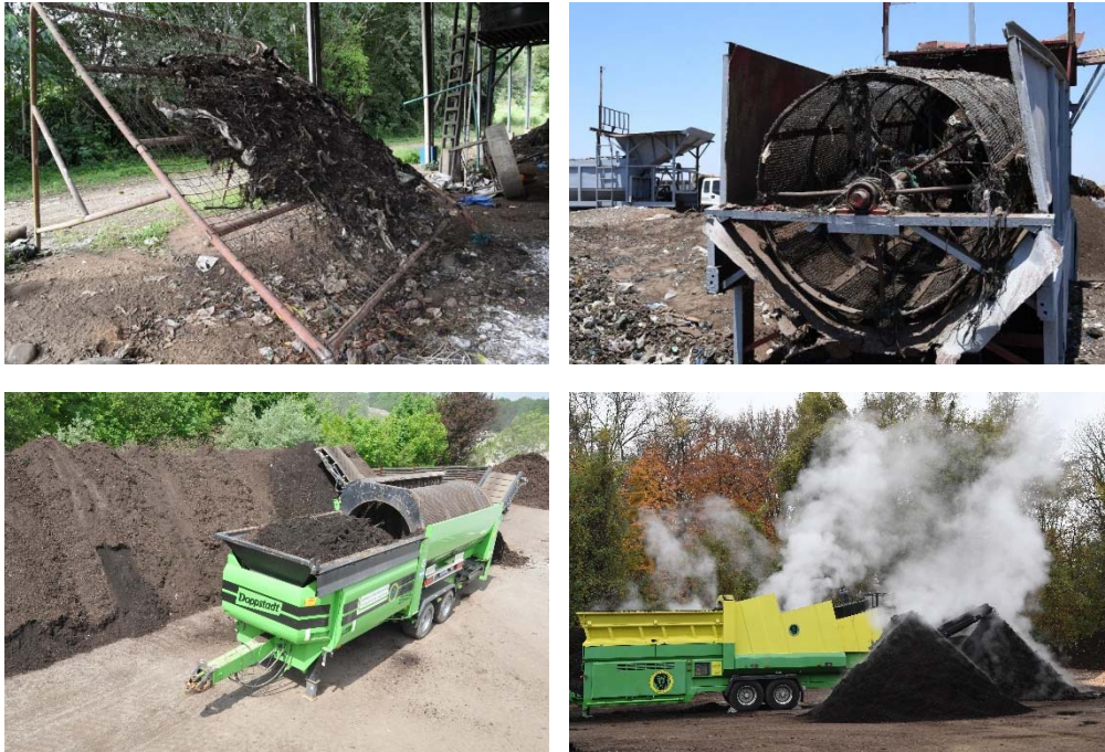
Fig. 11. Exemples d'un tamis artisanal, de deux cribles à tambour rotatifs et d'un crible à étoiles
